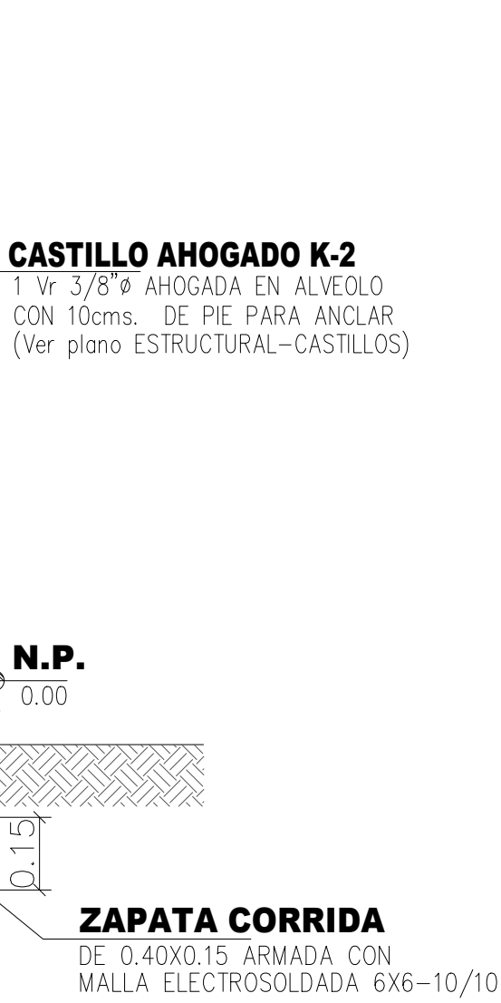
CIMENTACIÓN PARA BARDAS CABECERAS ZAPATA Z-1
